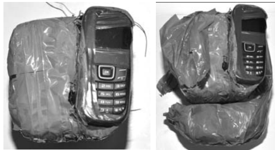
Fig. 10. Mbështjellja e të gjitha pjesëve përbërëse të PEI-t, me shirita ngjitës në mungesë të kontejnerit. 11
