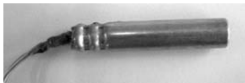
Fig. 8. Detonator/kapsollë elektrike me veshje alumini dhe përzierja piroteknike e një detonatori me veshje bakri 9 (1. Përzierësi piroteknik; 2. Majat e telave të detonatorit; 3. Veshja (kasa) prej materiali bakër)
