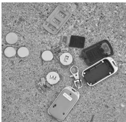
Fig. 4. Pajisje aktivizimi në distancë, duke shfrytëzuar sisteme të hapjes së dyerve të garazheve. 4
