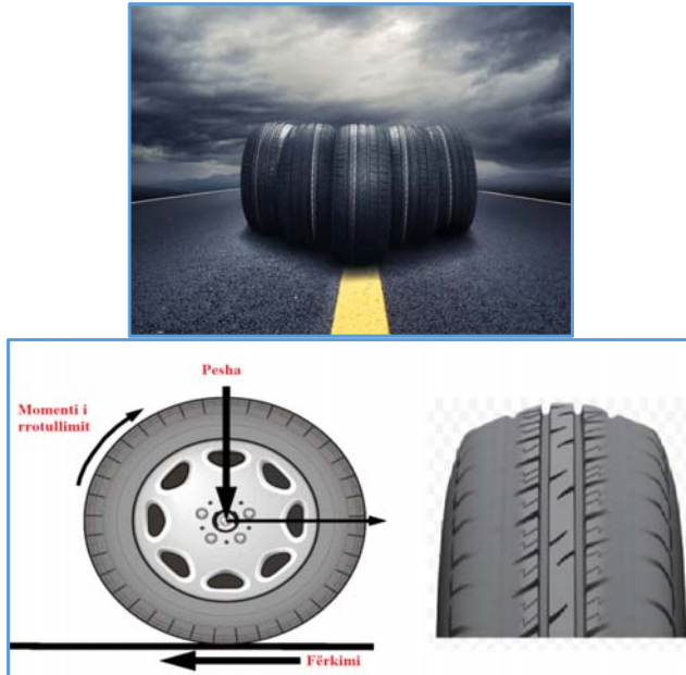
Fig.4. Gjendja e gomave dhe impakti në fërkimin me rrugën 4
